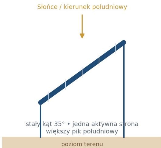
Rysunek 2. Geometria porównania: klasyczny stały układ południowy oraz pionowa orientacja E-W z dwiema aktywnymi stronami.
